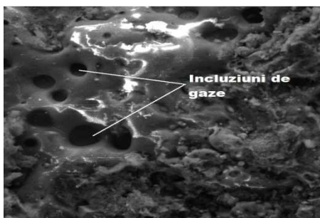
Figura 4.21. Imaginea obținută prin microscop electronic de scanare (SEM) a suprafeței crăițuite cu electrod învelit , Mărire de 1000X
