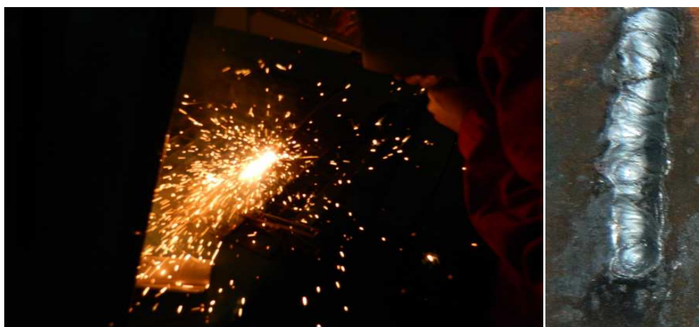
Figura 4.1 Proba piesei de grosimea de 10 mm obținută prin procedeul de crăițuire termică cu arc-aer
