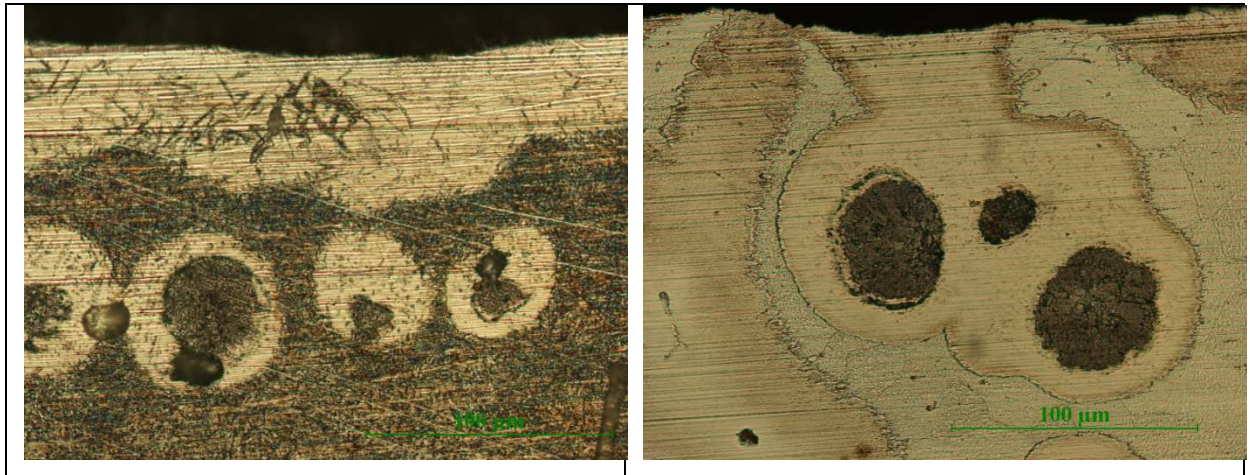
Figura 3.25. Microstructura zonei influențate termic: a) fonta ADI, b) fonta DI, mărire 500x, atacat nital 5%
