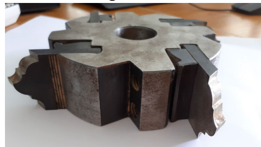
Fig. 44. The cutter head used in the milling process (Brenci și Gurău 2024)
