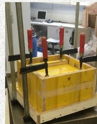
Compactare cu cleme de strângere cu șurub
