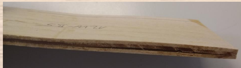
Placaj tristratificat din furnir de frasin încleiat cu cazeină
