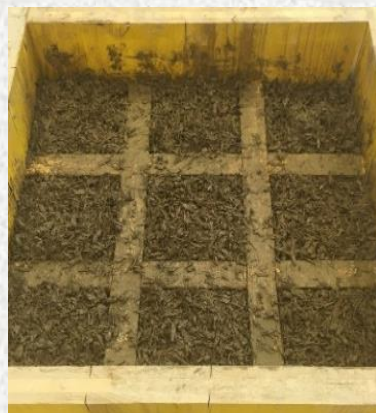
Epruvete de 10 x 10 x 10 cm realizate într-o forma compartimentată din placaj
