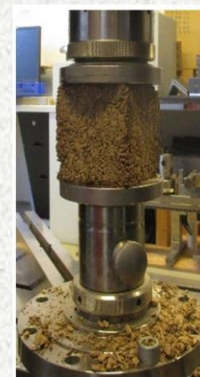
Testarea rezistenței la compresiune
