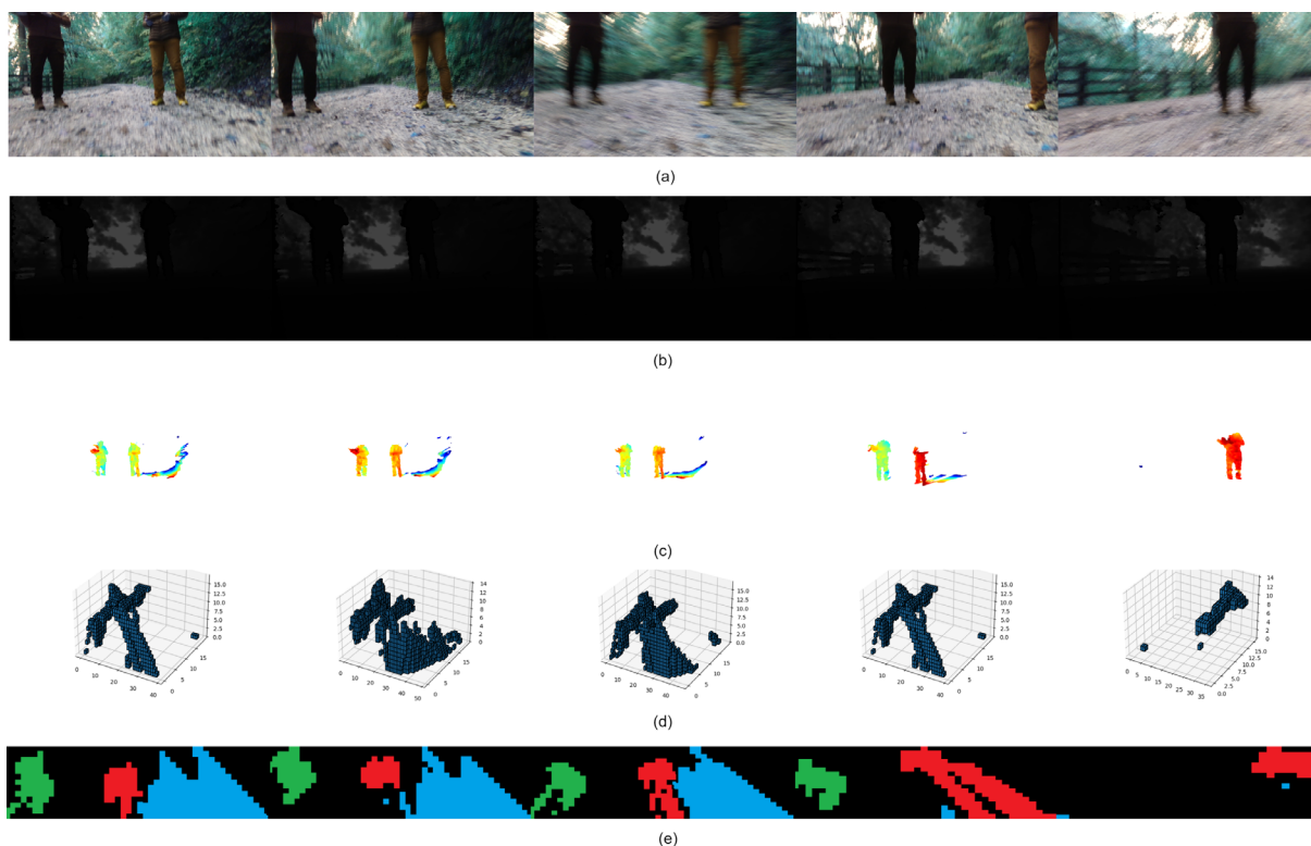
Fig. 52. Lanțul de procesare a datelor experimentale. Datele experimentale utilizate de algoritm. De sus în jos: (a)—date RGB, (b)—imagine de adâncime, (c)—reprezentare 3D, (d)—grilă de voxel 3D și (e)—grilă de voxel 2D.
