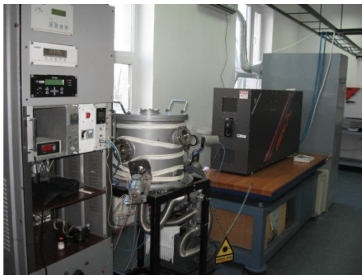
Fig. 1. Instalația experimentală PLD a Laboratorului de Interacțiuni Laser-Suprafețe-Plasmă din Institutul Național de Fizica Laserilor, Plasmei și Radiațiilor
