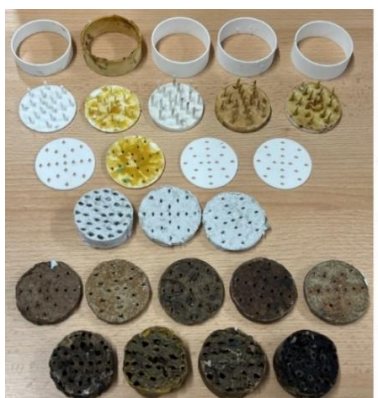
Figura 5.23. Panouri din materiale eco-compozite, a) inele de extracție; b) matrițe; c) extractoare; d) miezuri din celuloză; e) panouri fonoizolante [POP 24b]
