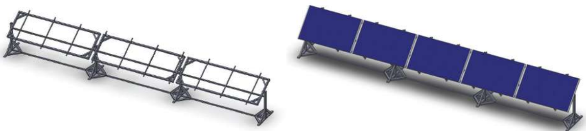
Fig. 4.49 Vedere de ansamblu a structurii metalice a unui șir cu 5 module fotovoltaice.
