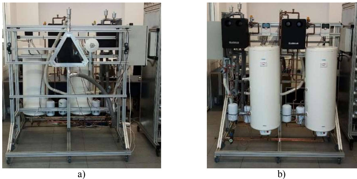
Fig. 2.61 Stand de testare pentru colectoare solar termice: a) vedere laterală cu colectorul solar termic instalat și simulatorul solar vertical; b) vedere laterală cu boilerele [Moldovan et al, 2021b]
