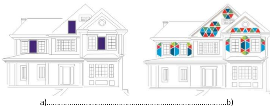
Fig. 2.31 Posibilități de implementare a colectoarelor solar termice comerciale (a) și necomerciale (b) în fațada sudică a unei clădiri de locuit [Visa et al, 2017d]
