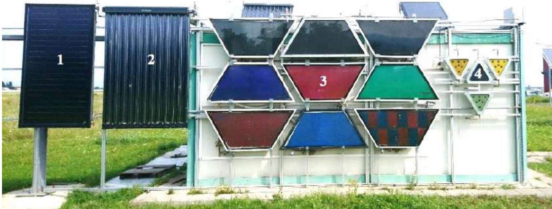
Fig. 2.52 Standul de testare în aer liber pentru colectoare solar termice [Moldovan et al, 2020b]
