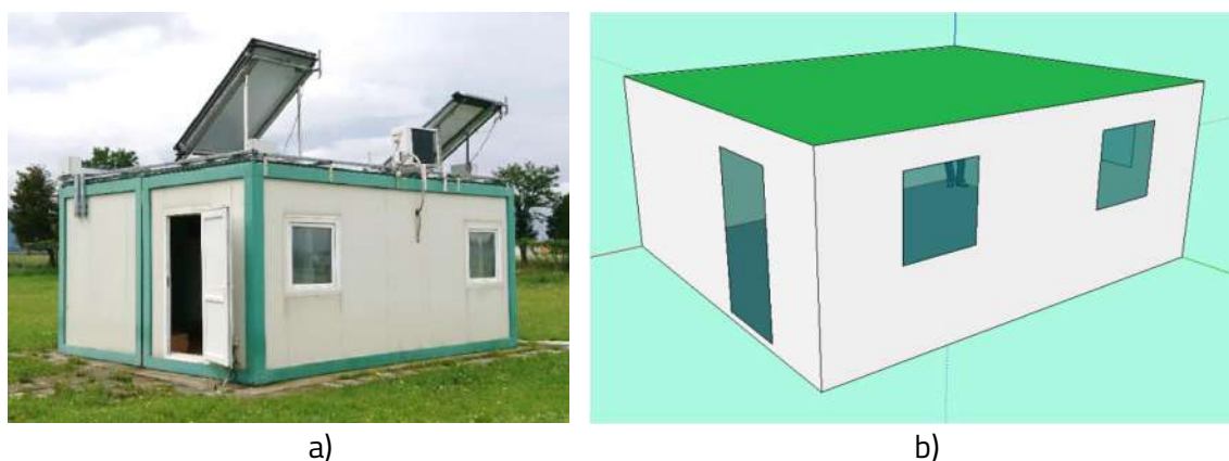
Fig. 2.24 Stand de testare în aer liber pentru colectoare solar termice: fotografie (a) și model 3D (b) [Moldovan et al, 2020]
