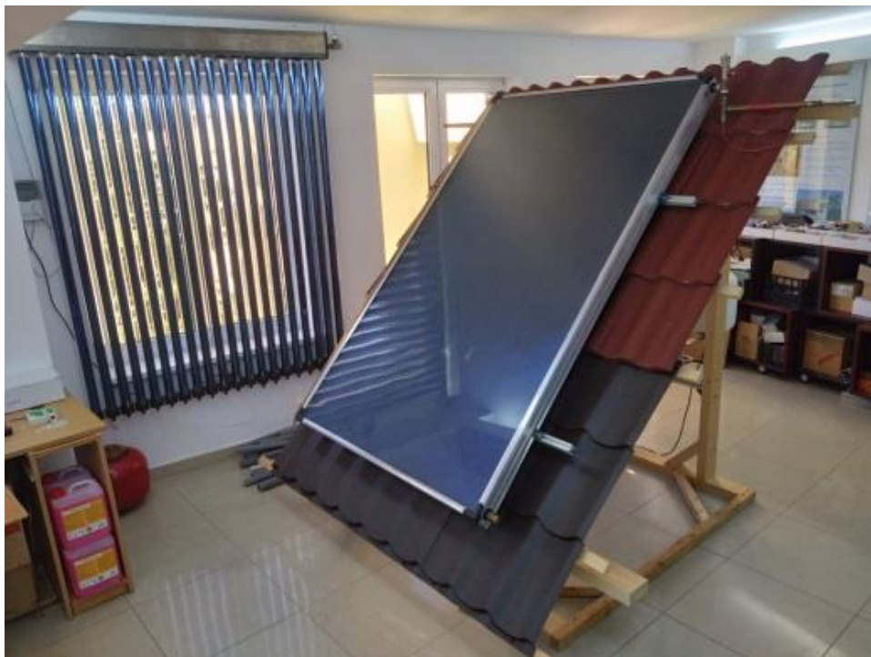
Colector plan plat – pe acoperiş Colector cu tuburi vidate - pe faţadă
