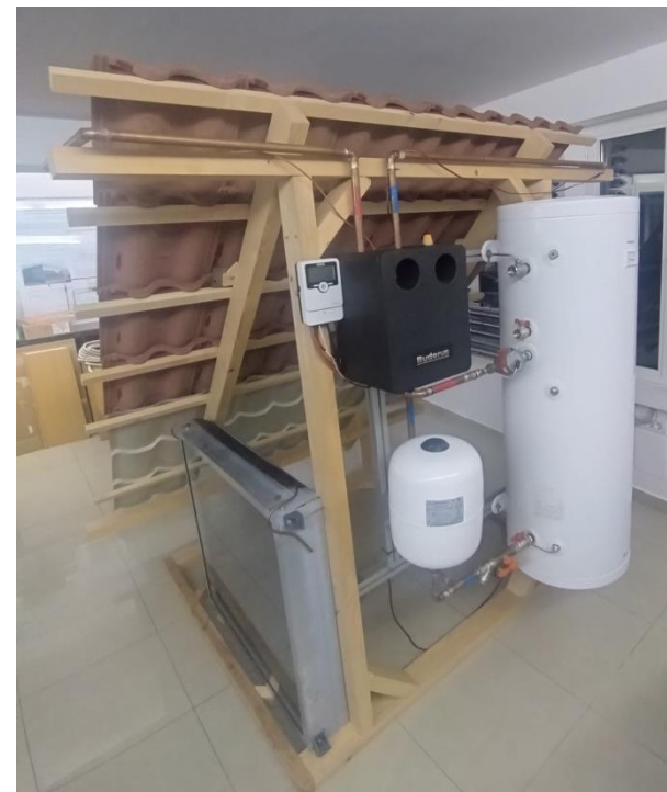
Boiler bivalent, Grup pompare Vas expansiune, Controler
