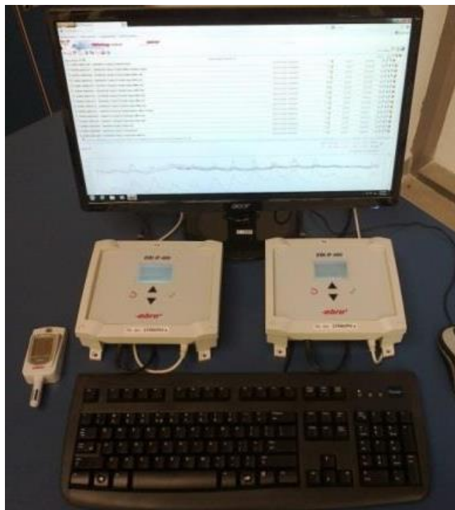
Senzori wireless pentru măsurarea temperaturii și umidității relative a aerului
