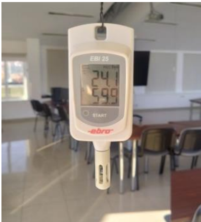
12 Senzori wireless pentru măsurarea temperaturii și umidității relative a aerului
