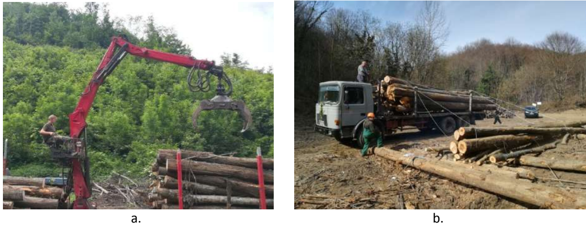
Figure 3.7. Autovehiculele luate în studiu (Mușat et al., 2024a): a. autotren forestier (ATF) echipat cu macara hidraulică; b. autoplatformă forestieră (APF) echipată cu troliu TA-2 AM
