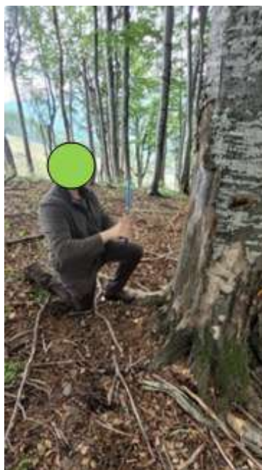
Figura 7.9. Folosirea burghiului Pressler pentru extragerea carotelor de creștere (Mușat, 2024a)
