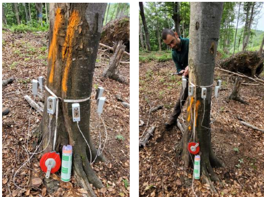
Figura 7.28. Defectele exterioare vizibile pe arborele de fag numărul 11 (Mușat, 2024b)
