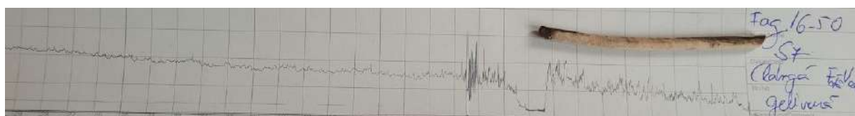
Figura 7.35. Rezistograma realizată și carota de creștere extrasă de la arborele de fag numărul 16, de pe direcția senzorului S_7 de la nivelul de 50 cm (Mușat, 2024a)
