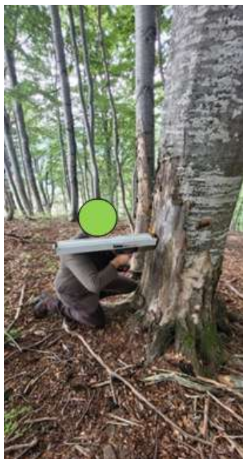
Figura 7.8. Investigații cu rezistograful IML Resi F-500S (Mușat, 2024a)
