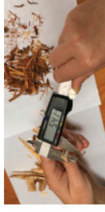
Figura 8.5. Măsurarea așchiilor (Scriba și Muşat, 2023): a. lungimea; b. lăţimea; c. grosimea
