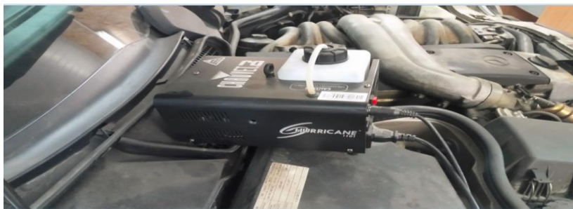
Fig. 62 Generatorul de fum Hurricane 1011 poziționat la priza de admisie a sistemului de ventilație și aer condiționat.
