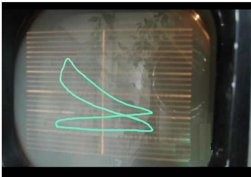
Fig.43 Diagrama indicată pentru modul de ardere HCCI
