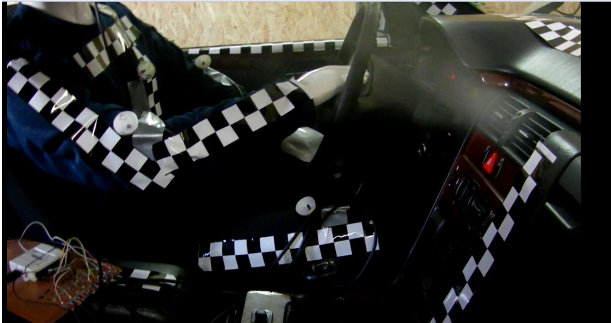
Fig. 63 Jetul de aer al sistemului de aer condiționat clasic, stadiu incipient
