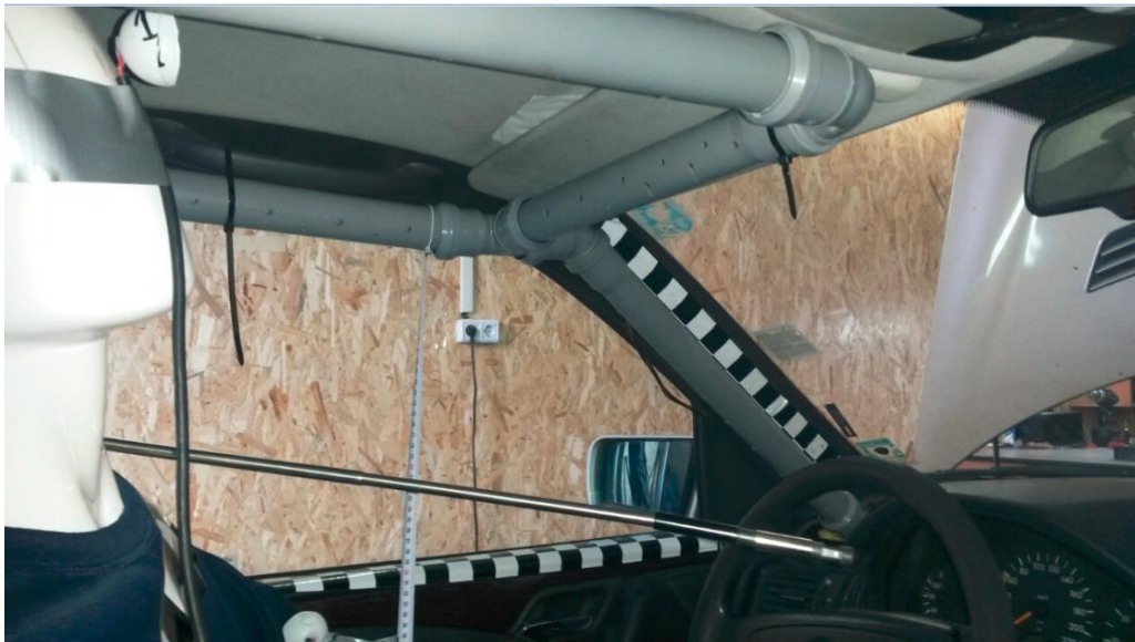
Fig. 76 Anemometrul poziționat la perdeaua cu jeturi circulare turbulente la 0,4 m
