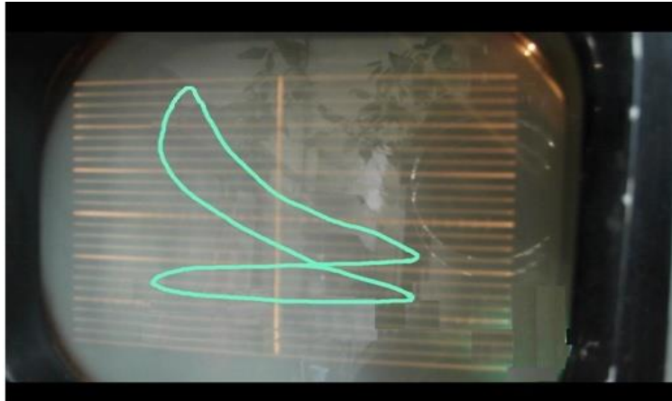
Fig.42 Diagrama indicată pentru modul de funcționare cu aprindere prin scânteie.
