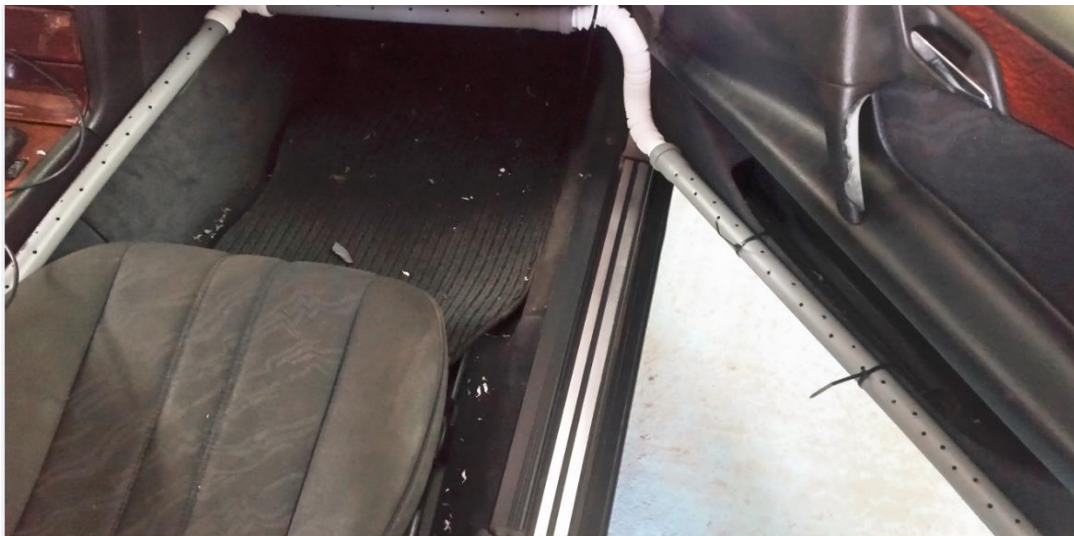
Fig. 61 Tubulatura perdelei cu jeturi de aer circulare turbulente montata la nivelul scaunului
