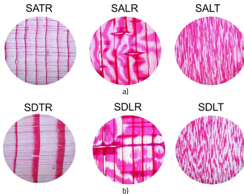
Figura 2. 24. Caracteristici anatomice ale probelor de lemn de molid (mărire x4): a) molid clasa A, secțiune transversală (TR), secțiune longitudinal-radială (LR) și secțiune longitudinal-tangențială (LT); b) molid clasa D, secțiune transversală (TR), secțiune longitudinal-radială (LR) și secțiune longitudinal-tangențială (LT) (Guiman ș.a. 2023, Stanciu ș.a. 2025c)
