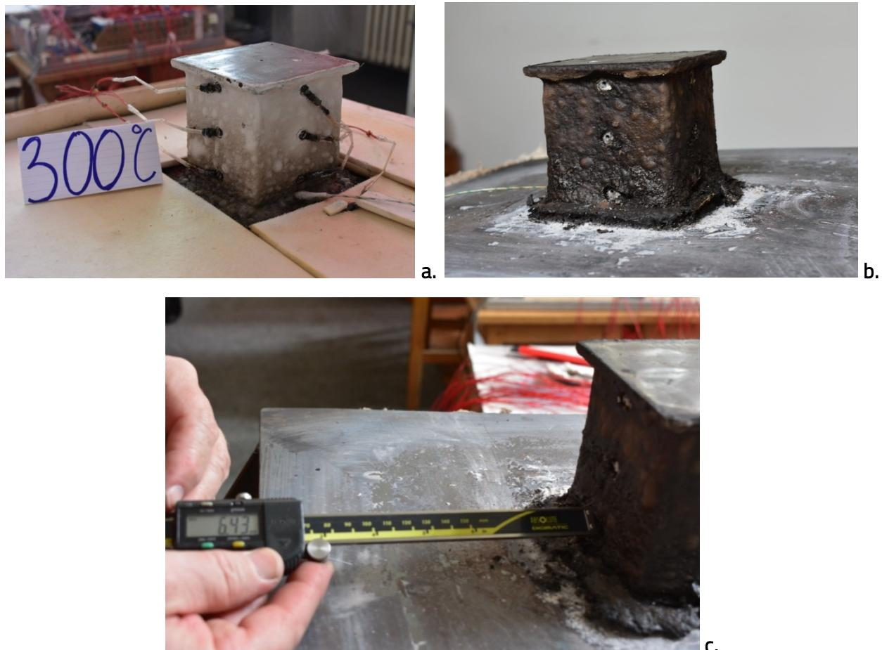
**Fig.4.1.14.** Stâlpul redus la scara 1:4 la temperatura de a.)  $300\text{ }^{\circ}\text{C}$ ; b.)  $500\text{ }^{\circ}\text{C}$ ;
