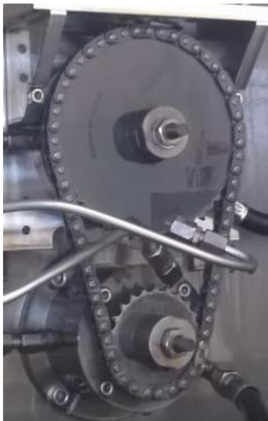
Figura 3.1 Standul cu transmisia prin lanţ cu i=2 .
