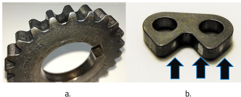
Figura 6.27. Urme de uzură pe eclisa de mijloc a lanțului LD6, în dreapta eclisă de mijloc, în mijloc și în stânga eclisă de interior.
