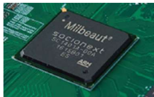
Figura 56: Circuit integrat care implementează sistemul de stabilizare a imaginilor
