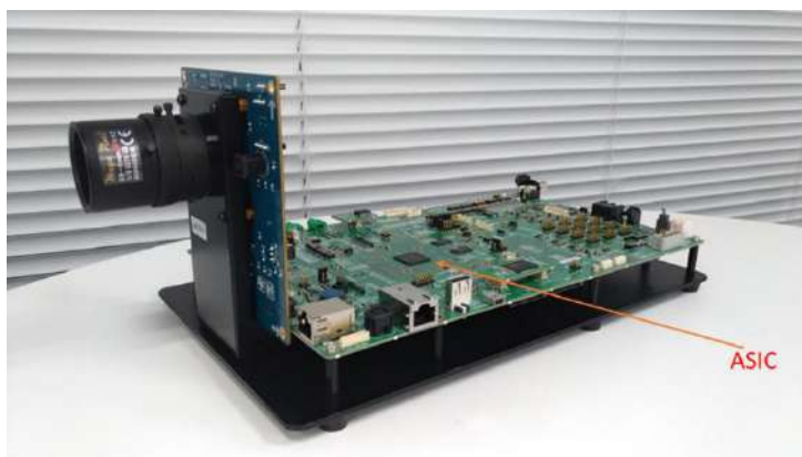
Figura 53: Placă de dezvoltare pentru validarea funcționării ASIC
