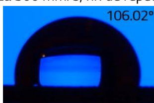
Figura 6.19. Imagini cu rezultatele obținute pentru unghiului de contact static, frecvență 60 kHz, viteză 600 mm/s, nr. de repetări 1.
