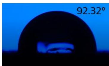
Figure 6.3. Imaginea unghiului de contact static, frecvență 35 kHz, viteză 350 mm/s, nr. de repetări 20.
