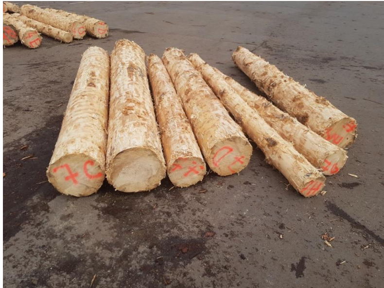
Fig. 3.11: Grup de buşteni având diametrul la capătul subţire între 270 mm şi 330 mm
