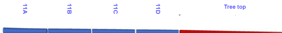
Fig. 3.6: Simulare 3-D a secţionării lemnului rotund N° 11 în 5 buşteni, dintre care 4 au fost clasificaţi ca buşteni de cherestea (11A ... 11D) şi unul (vârful) ca lemn de foc
