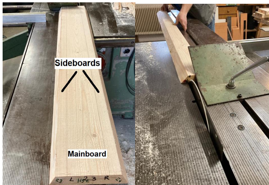
Fig. 4.13: Scândură cu linia de margine optima Fig. 4.14: Separarea piesei laterale de cea centrală
