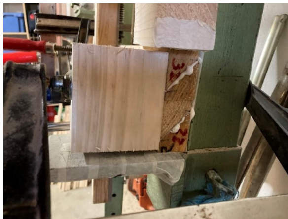
Fig. 4.15: Încleierea şi presarea pieselor reconstituite din laterale conice
