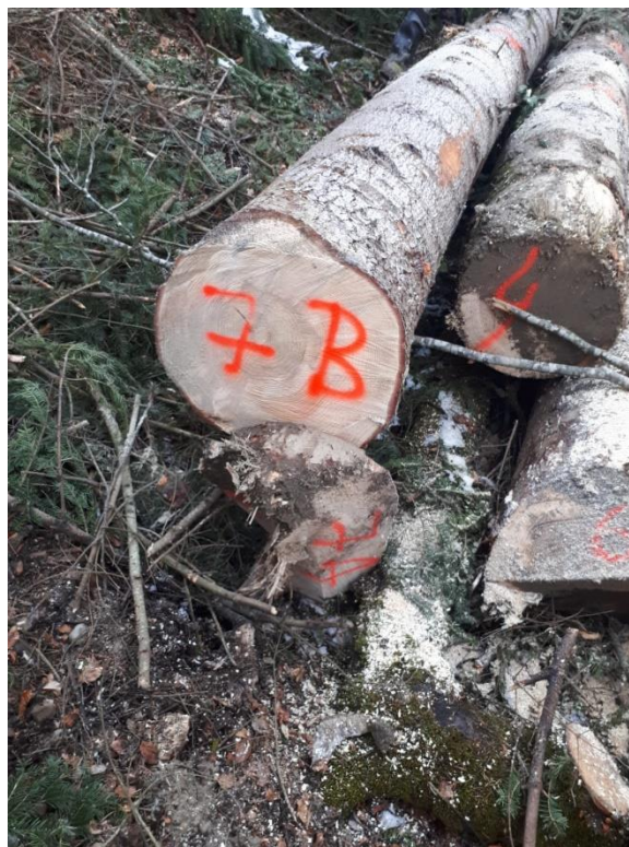
Fig. 3.5: Evaluarea calitativă şi secţionarea lemnului rotund
