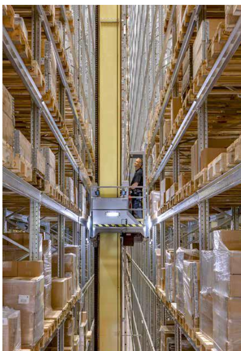
Figura 2.7. Sistem de rafturi cu macarale (**a, 2019).
