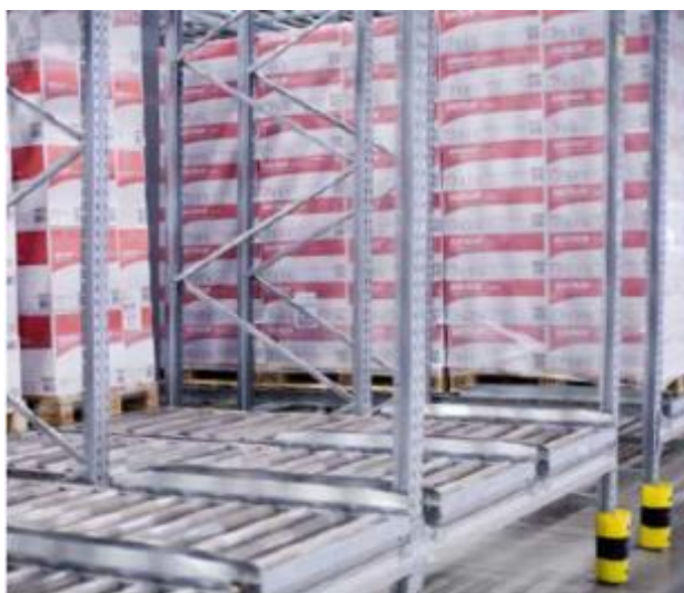
Figura 2.5. Sistem de rafturi cu role pentru paleți (**a, 2019).
