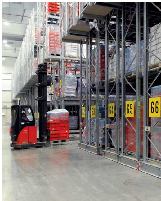
Figura 2.6.. Sistem de rafturi mobile (**a, 2019).
