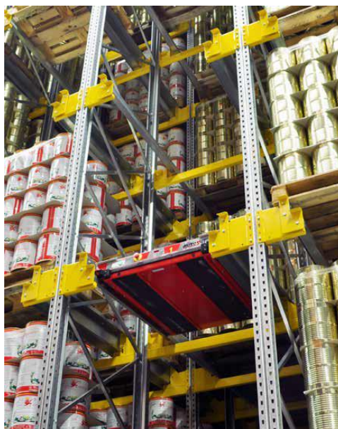
Figura 2.4. Sistem de rafturi cu cărucior automat (**a, 2019).
