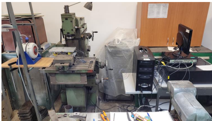
Figura 5.38 Testul modal al dinamometrului utilizând semnalul de intrare a agitatorului în direcția longitudinală (direcția Ox)
