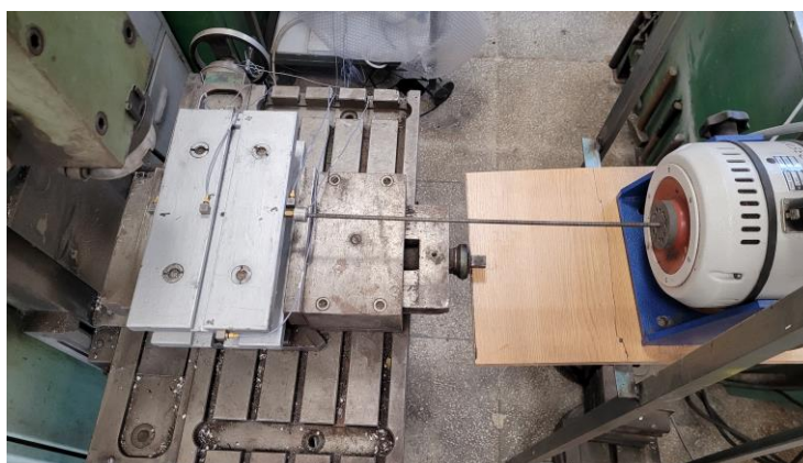
Figura 5.42 Testul modal al dinamometrului folosind semnalul de intrare a agitatorului în direcție transversală (direcția Oy)
