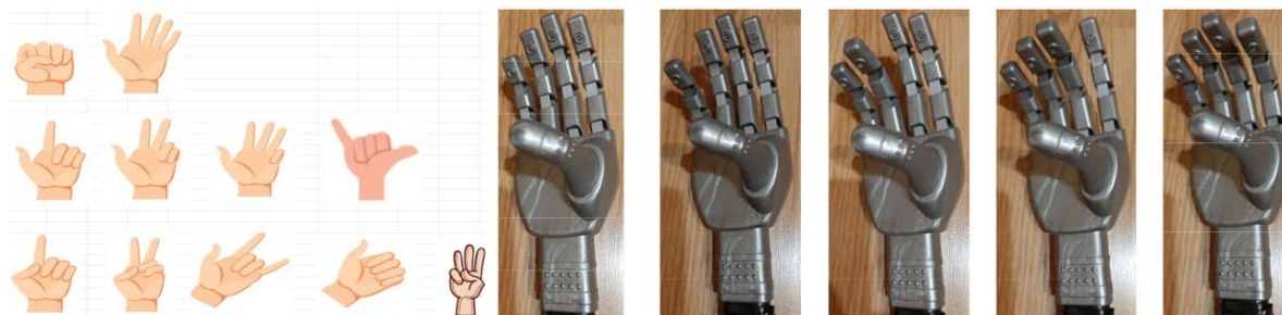
Figura 7.1.5.3. Pozițiile intermediare care constituie comenzile necesare la experimentarea aplicației BCI pentru controlul mâinii robotice utilizând casca EEG NeuroSky și Arduino.
