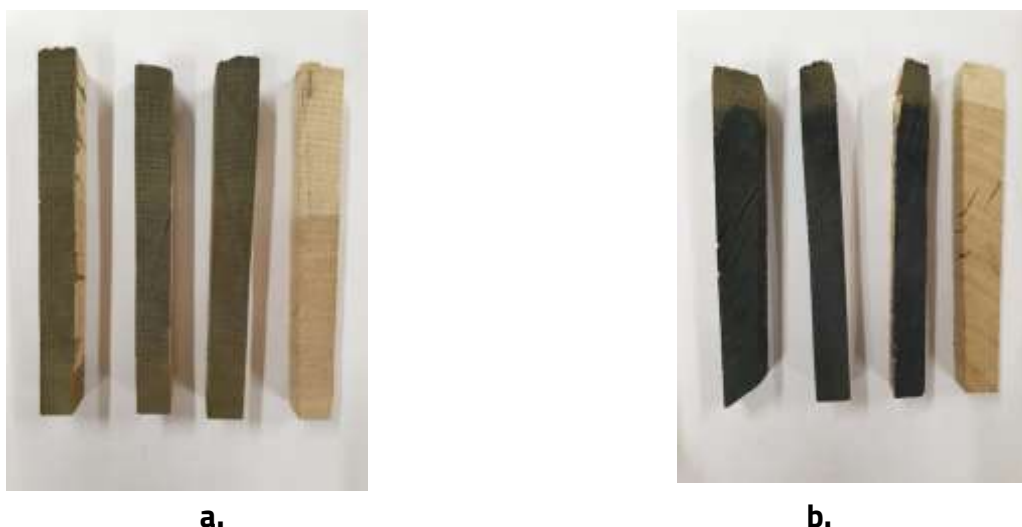
Fig. 4.15 Modificarea de culoare a lemnului de cer (a) și gorun(b) după aplicarea \text{FeCl}_3
