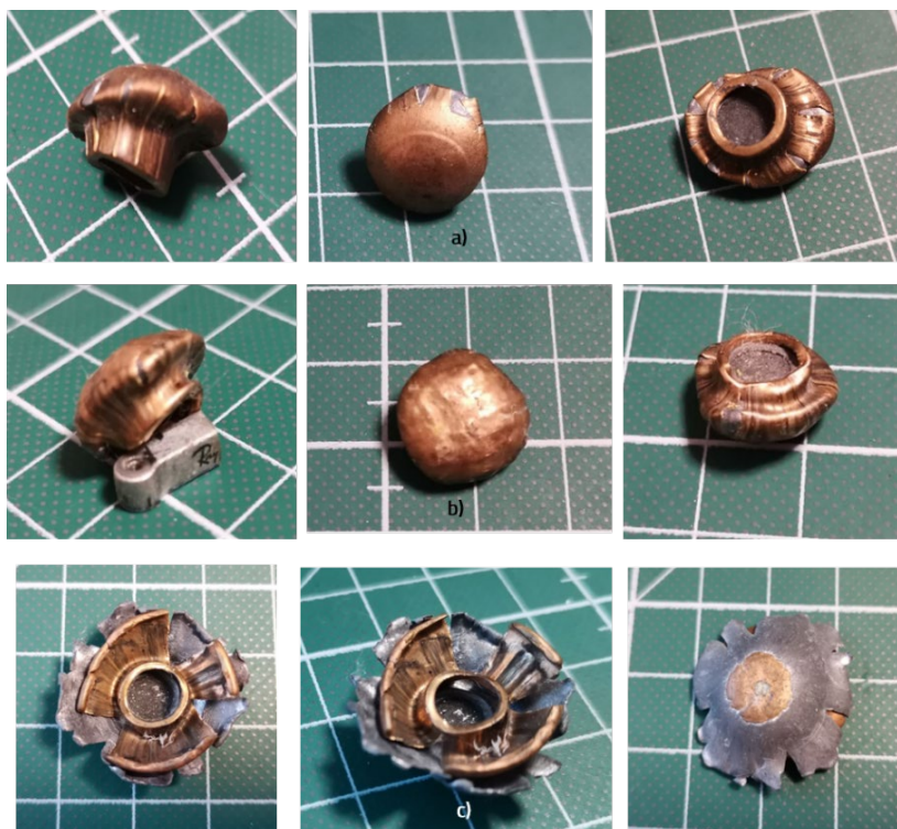
Figura 5.10 Deformarea proiectilului după impact: a) configurația PE-RCP-S; b) configurația PE-RCP-F; c) configurația PE-RCP-B
