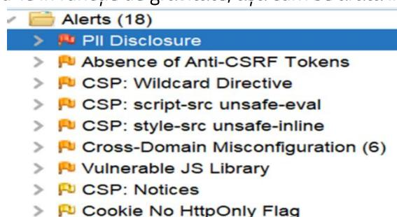
Figura 2.2. Vulnerabilități detectate identificate în timpul interceptării traficului cu OWASP ZAP
