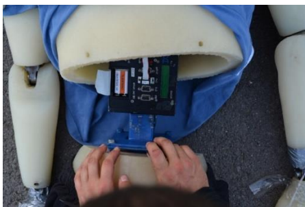
Figura 5.10 Instalarea accelerometrului PicDAQ 5 în interiorul toracelui manechinului
