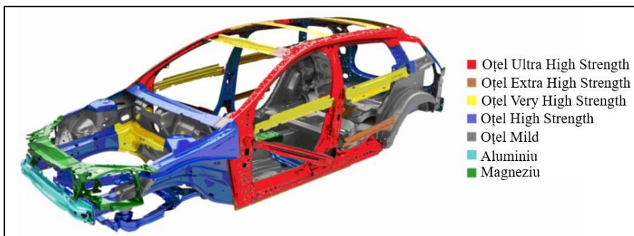
Figura 2.4 Materialele din care este realizată caroseria unui autovehicul [22]
