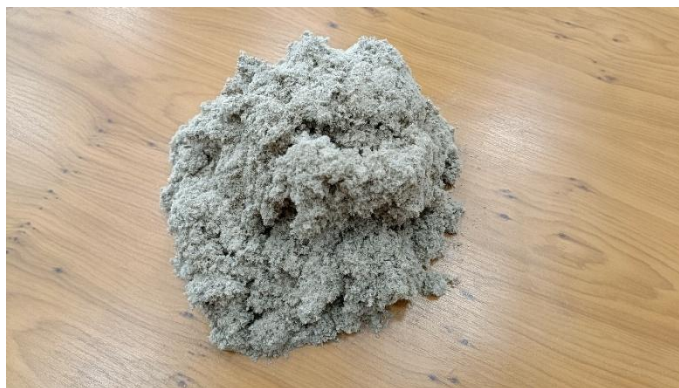
Figura6 . Amestecul de materii prime pentru panourile compozite de tip spumă obținute prin procesul uscat.
