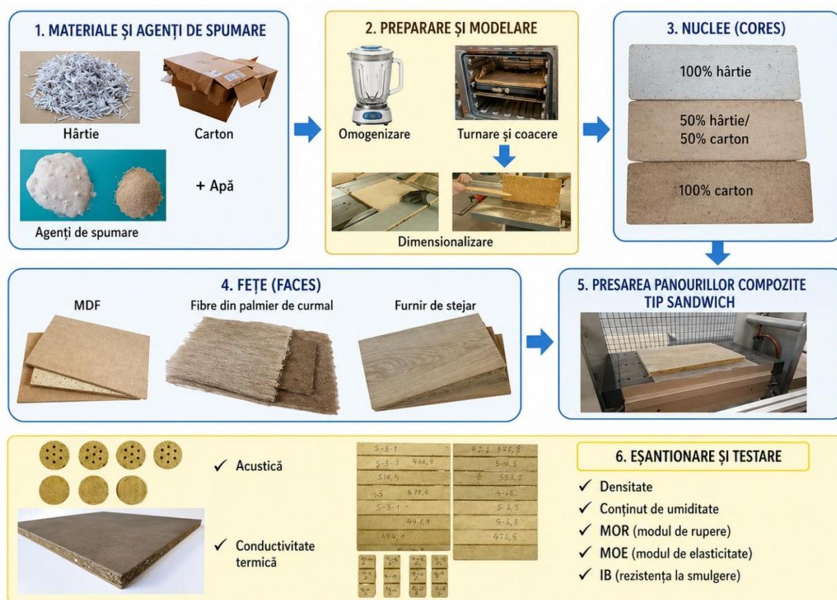
Figura 48. Panouri tip sandwich fabricate din miezuri compozite din spumă selectate, cu diferite straturi de acoperire.
