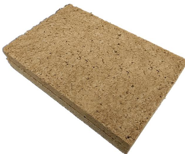
Figura 20. Compozite ușoare realizate din carton reciclat, bicarbonat de sodiu, praf de copt și oțet ca agenți de spumare.
