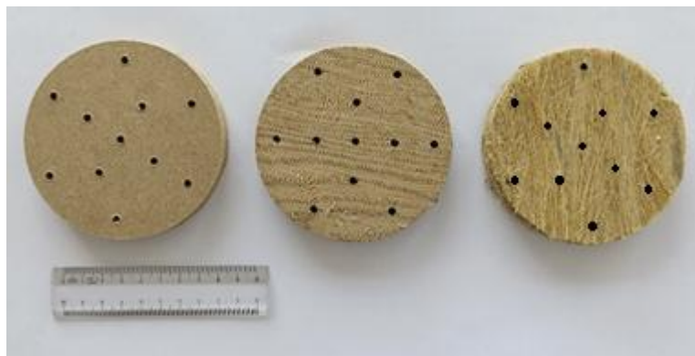
Figura 10. Probele pregătite din panouri compozite poroase (a) și panouri sandwich (b: neperforate, c: perforate) pentru testarea frecvențelor joase.
