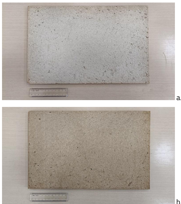
Figura38. Compozite realizate din hârtie mărunțită (a) și deșeuri mixte de carton și hârtie (b) folosind bicarbonat de sodiu și drojdie ca agenți de spumare.
