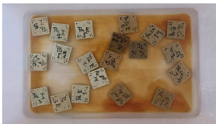
Figura9. Scufundarea probelor în apă pentru evaluarea stabilității dimensionale.
