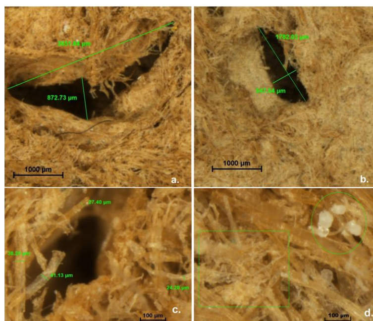
Figura 17. Măsurători la o mărire de 30x ale compozitelor UcSCs 100-100 și UcSCs 100-200: a. 3,5 % amidon de porumb; b. 7 % amidon de porumb; c. mărire de 180x; d. Aderența fibrelor (zona pătrată) și prezența amidonului de porumb (zona încercuită) la o mărire de 300x.
