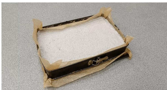
Figura5 . Amestecul de materii prime (procesul de turnare) al panourilor compozite de tip spumă obținute prin procesul umed.
