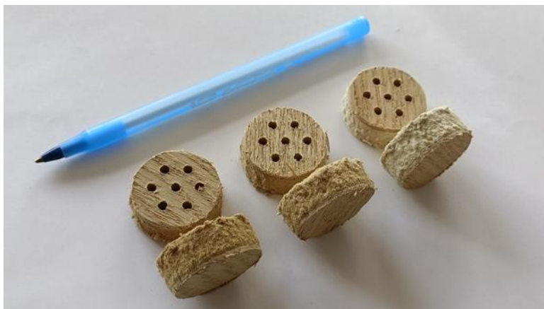
Figura 11 . Probe din panouri compozite poroase (a, neperforate și perforate) și panouri tip sandwich (b, neperforate și perforate) pentru testarea absorbției acustice la frecvențe joase.
