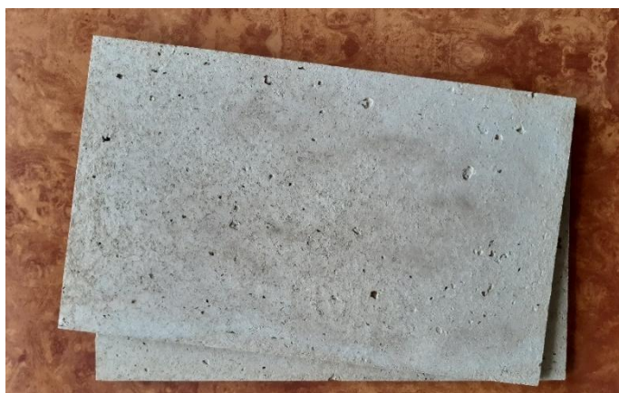
Figura 13. Panou compozit fabricat din carton reciclat, cu agenți de expandare: bicarbonat de sodiu și amidon de porumb.
