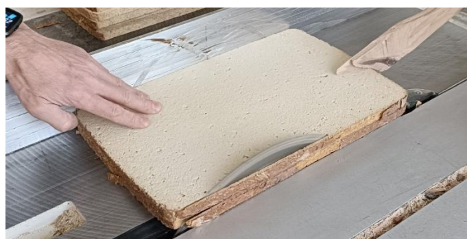
Figura 8 . Panoul compozit final, după tăierea la dimensiune, cu ajutorul unui ferăstrău circular.
