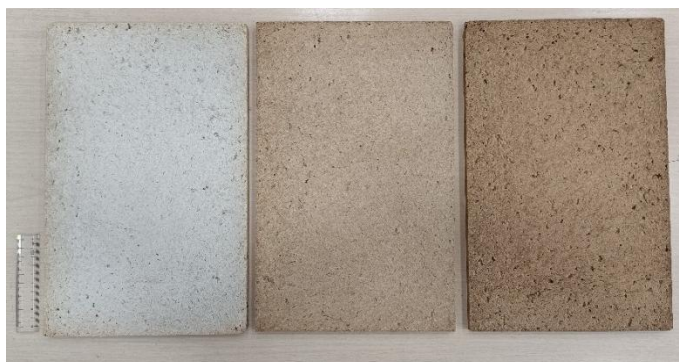
Figura4 . Compozite realizate din deșeuri de carton, hârtie reciclată și amestecuri de hârtie și carton.
