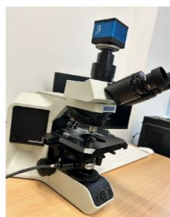
Sistem de microscopie în câmp întunecat îmbunătățit pentru imagini la scală nano cu posibilitate de upgrade cu modul hiperspectral
